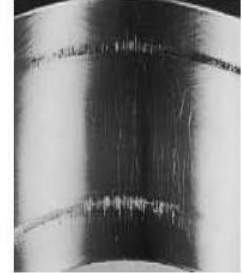
Depoda korozyona uğrama. Aşınma, nemin yoğunlaştığı makara
